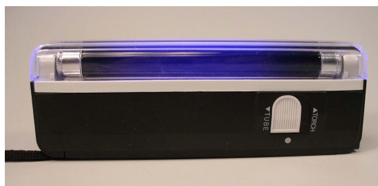
Denne UV lampe udsender en del UVA og er velegnet til demoforsøg og øvelser.
